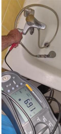
**Description :** Locaux contenant une baignoire ou une douche : la continuité électrique de la LIAISON EQUIPOTENTIELLE supplémentaire, reliant les ELEMENTS CONDUCTEURS et les MASSES des MATERIELS ELECTRIQUES, n'est pas satisfaisante (résistance > 2 ohms).
